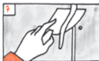
7. ...24 heures minimum après la pose et à l'aide d'une spatule, arasez l'excédent de colle durcie.
