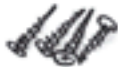
Vis autoperceuses FERMACELL (Conseil pour une utilisation judi- cieuse : 3,9 x 19 mm pour plaques en épaisseur 20 mm et 3,9 x 22 mm pour plaques avec isolant) __ m 2 x 15 = __ vis
